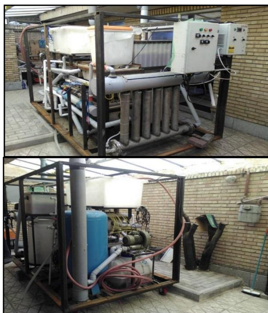
شکل (۳) تصویری از ماکت آزمایشگاهی شبیه سازی شده تأسیسات آب شیرین کن الکتروکوگولانانس
